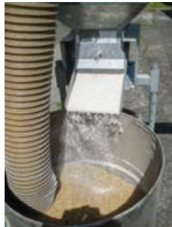
Photo de gauche: Applicateur pour le mélange de Silico-Sec avec le grain. Photo de droite: pistolet à air comprimé pour le traitement des locaux vides. Les deux appareils peuvent être obtenus sur demande auprès d'Andermatt Biocontrol Suisse.
