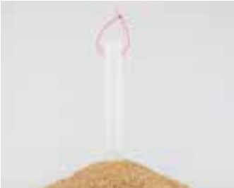
Piège à insectes pour la détection précoce des insectes nuisibles dans les céréales en vrac.
