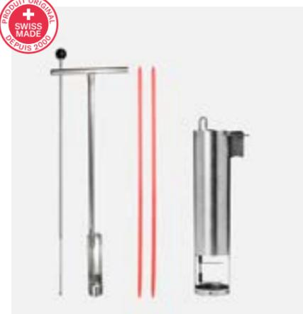
De gauche à droite: sonde, tarière, jalons et piège topcat.
