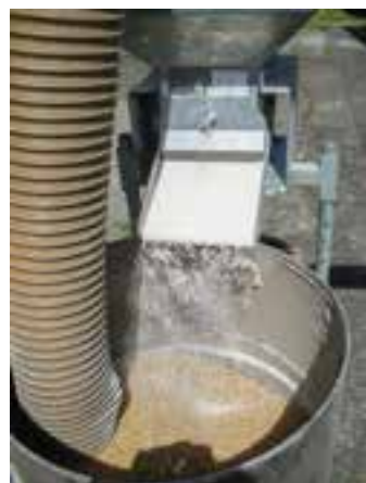
Applikator für Einmischung von Silico-Sec in Getreide
